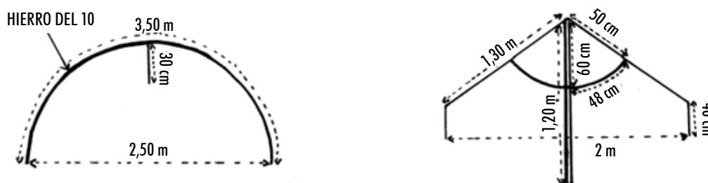
Figura N°1.- Diversas estructuras con sus dimensiones
